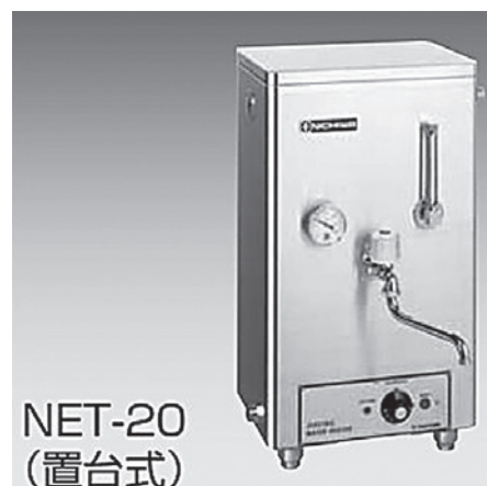
写真5 給湯設備（83℃以上） 熱水消毒用給湯設備で83℃以上の熱湯で調理器具の消毒処理に使用する
