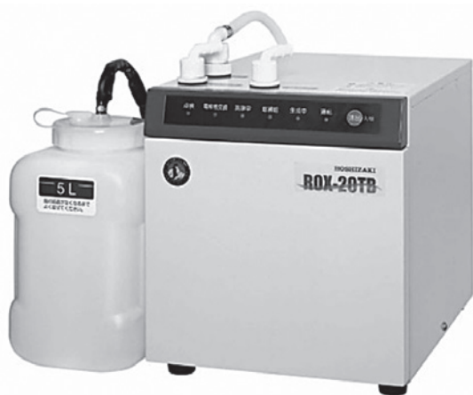
写真2 電解水生成装置 電解水生成装置は食塩水を電気分解して、 殺菌用の酸性水と洗浄用のアルカリ性水を作る装置。 加工場の衛生管理に活用。
