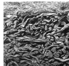
鹿皮革断面の顕微鏡写真
