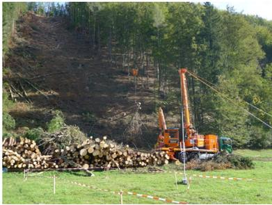
図10 タワーヤードとプロセッサのコンビマシン
