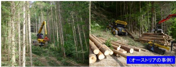
図17 ウインチアシストシステム
